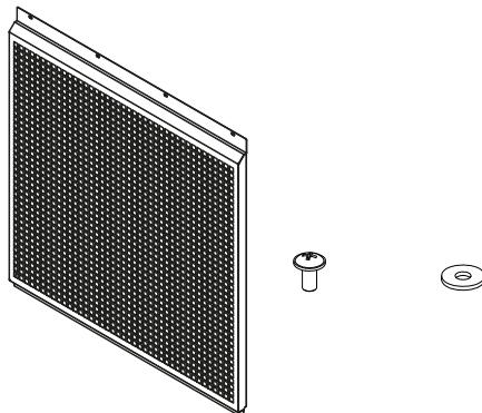
1 x Verdampferschutzgitter      8 x Schraube M5      8 x Kunststoffunterlegscheibe
