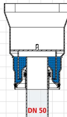
Der Trichtersiphon ist geprüft nach DIN-EN 274 vom MPA-NRW.
