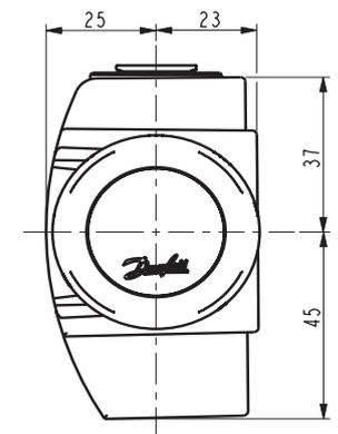
VHS-DV Durchgangsventil mit Abdeckung (RAX-Fühler, an Position 3)
