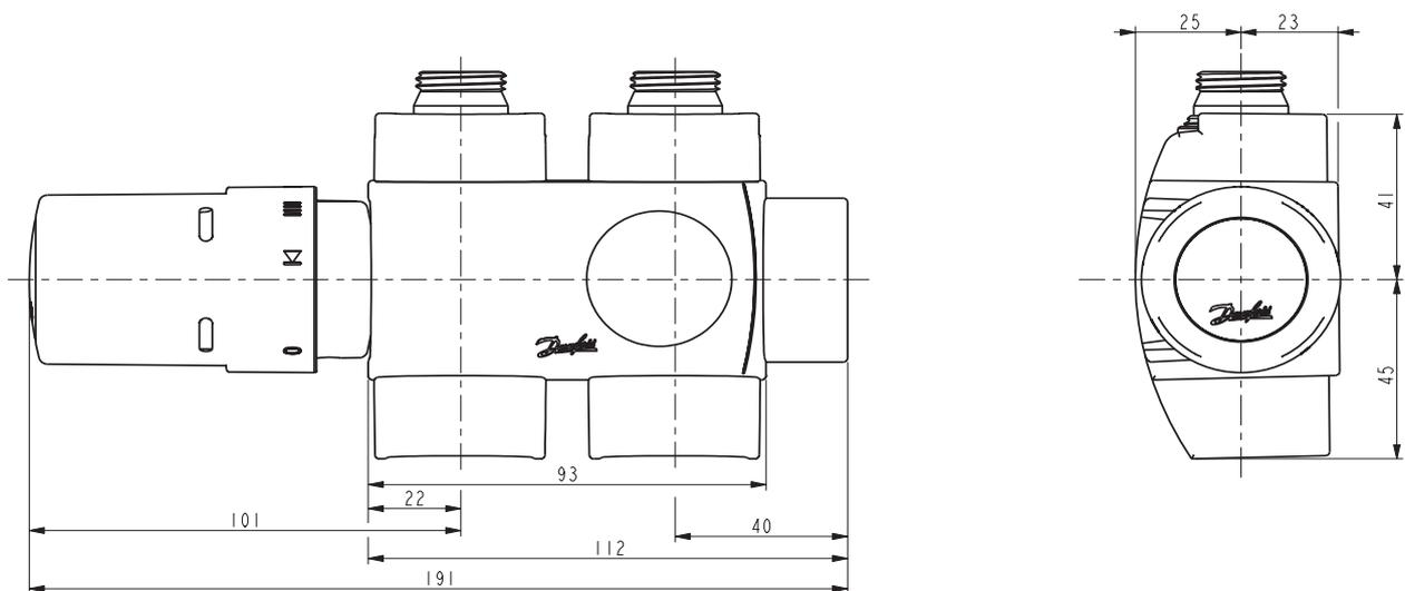
VHS-DV Durchgangsventil (RAX-Fühler, an Position 3)
