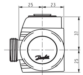
VHS-DV Eckventil mit Abdeckung (RAX-Fühler, an Position 3)
