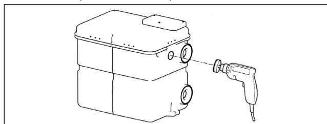
**AVIS !** Ne pas endommager les surfaces d'étanchéité, utiliser un joint emboîté et décaler ensuite la conduite d'arrivée et d'aération  $\varnothing 50$  d'environ 35 mm dans les joints emboîtés.
