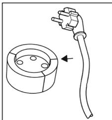
4. La linea di rete della pompa viene fatta passare con la spina attraverso l'apposita apertura di  $\varnothing$  70 nel coperchio.
