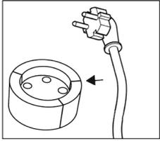
Den Verschlussstopfen aufknicken und Netzleitung einlegen. Leitung im Behälter so kurz halten, dass der Schwimmer frei beweglich bleibt. Es ist jedoch darauf zu achten, dass die Länge der Leitung eine Deckeldemontage zulässt.
