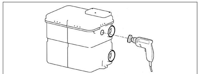
**HINWEIS!** Dichtflächen nicht beschädigen, Steckdichtung einsetzen und anschließend die Zulauf- und Lüftungsleitung ø 50 ca. 35 mm in die Steckdichtungen schieben.
