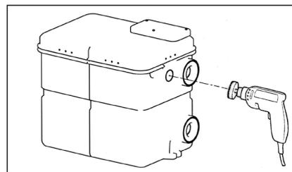
**LET OP!** Afdichtingsvlakken niet beschadigen, insteekdichting plaatsen en aansluitend de toevoer- en verluchtungsleiding  $\varnothing 50$  ca. 35 mm in de insteekdichtingen schuiven.
