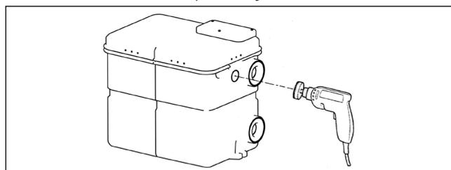
**AVVISO!** Non danneggiare le superfici a tenuta, utilizzare la guarnizione a spina e spostare successivamente la linea di afflusso e di ventilazione  $\varnothing 50$  ca. 35 mm nelle guarnizioni a spina.
