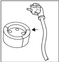
De afsluitstoppen openknikken en de stroomnetleiding plaatsen. Leiding in het reservoir zo kort houden dat de vlotter vrij kan bewegen. Er dient op gelet te worden dat de lengte van de leiding een dekseldemontage toelaat.
