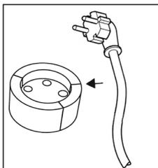
4. Le câble secteur de la pompe est dirigé avec le connecteur via l'ouverture  $\varnothing$  70 prévue à cet effet dans le couvercle.
