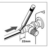
9. Achten Sie auf eine korrekte, mittige Platzierung der Pressfit-Ventile in der Pressbacke.
