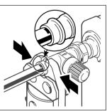
11. Führen Sie die Voreinstellung am Ventilgehäuse durch.
