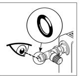
8. Führen Sie das Rohr 22 mm in die Pressmuffe des Ventilgehäuse ein und markieren Sie das Rohr an dieser Stelle.
