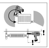
Führen Sie die Montage des Ventilanschlussnippels am Heizkörper durch. Achten Sie darauf, ob die Dichtungsfläche für den O-ring intakt ist. Sollte dies nicht der Fall sein, bitte traditionelles Dichtungs-material verwenden.
