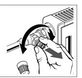
12. Installieren Sie das Fühlerelement.
