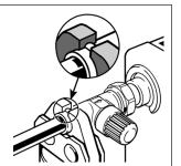
10. Überprüfen Sie, ob das Rohr während der Pressung entsprechend der vorgenommenen Markierung zusammengedrückt wurde. Wenn alle Installationen an der Anlage durchgeführt sind, wird die Druckprobe durchgeführt und die Anlage gespült und gefüllt.
