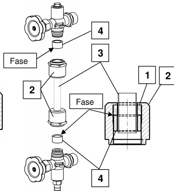
Sichtrohr (Pos.3) zwischen den Absperrhähnen ausrichten und die Überwurfmutter (Pos.2) fest anziehen. Dabei das Sichtrohr durch Festhalten gegen Verdrehen sichern
