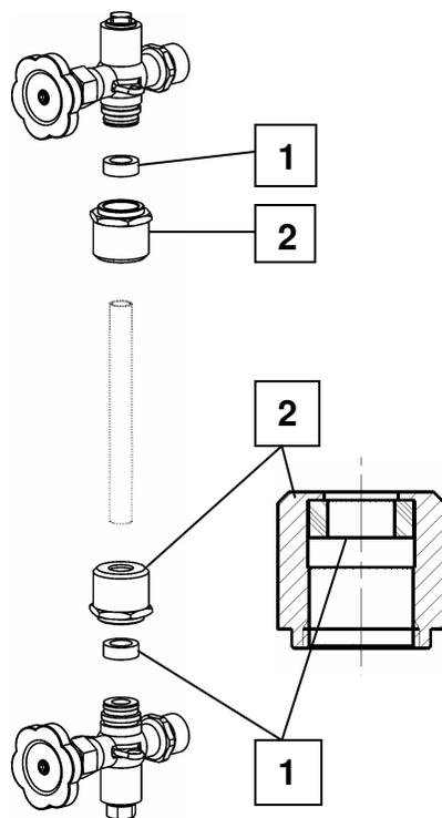
Überwurfmutter (Pos.2) mit Dichtung über das Sichtrohr (Pos.3) schieben
