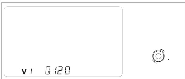
7. Senken oder erhöhen Sie den Wert des Luftvolumenstroms (m<sup>3</sup>/h) mit dem Touchpad.
